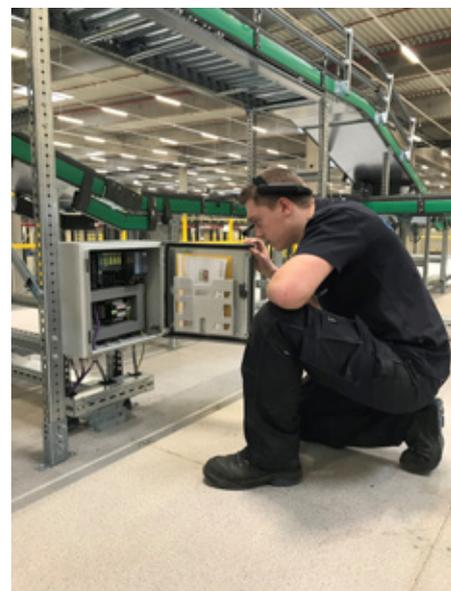
*Dem Servicetechniker werden über die BEUMER Smart Glasses alle wichtigen Informationen in das Livebild der Gerätekamera eingeblendet. Bild: BEUMER*
