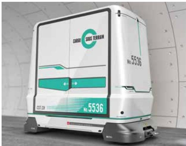
Die CST-Fahrzeuge verkehren im Tunnel vollautomatisch mit einer Geschwindigkeit von 30 Kilometern. Bild: CST
