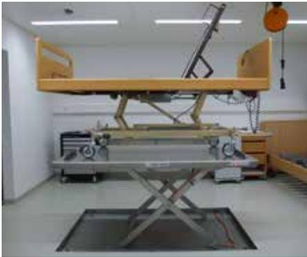
Reinigung sowie auch der Unterhalt der Spitalbetten werden auf diesen ergonomischen Flachhubtischen, welche eine sehr geringe Bauhöhe aufweisen, erledigt. Damit ist eine rückschonende Arbeitsweise sichergestellt. Gebäudeintern wie auch extern findet Steinbock Handling AG seine Aufgaben im Bereich Lifte und Hebebühnen für Behinderte. Da
