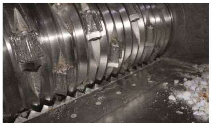
Entscheidend ist das Schneidwerk. Je nach Anwendung ist ein grosser Rortordurchmesser verbaut, der mit gehärteten konkaven Werkzeugen bestückt ist. Bild: Vecoplan AG
