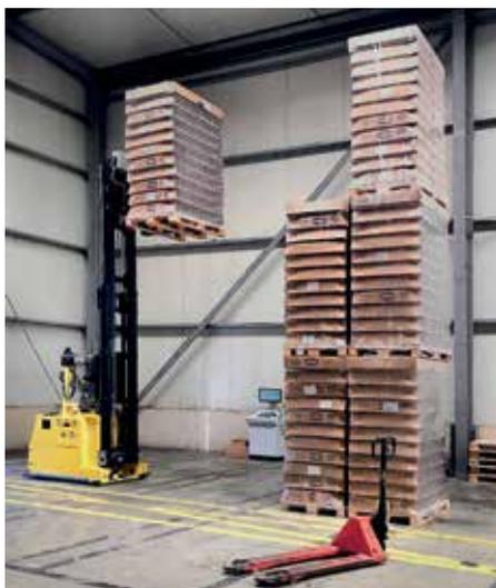
*Erfolgreicher Praxistest: erstmalig setzt EK AUTOMATION 3D-Kameras in Verbindung mit einer innovativen Software zur Bildauswertung ein, um auch instabile Lasten präzise und sicher zu stapeln. Bild: EK AUTOMATION*
