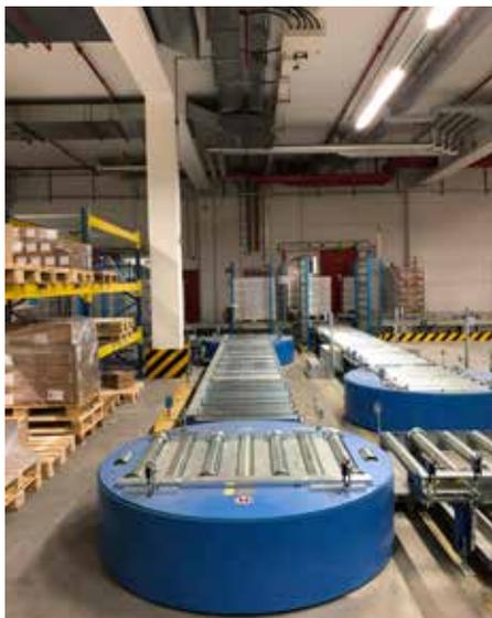
Im Erdgeschoss wurden Drehtische zur Anbindung der bestehenden Förderanlage an das Hochregallager integriert. Bild: MLOG Logistics GmbH
