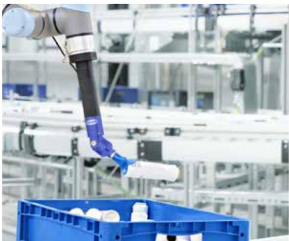
Den Bin-Picker SBPG liefert Schmalz anschlussfertig und mit integrierter Vakuum-Erzeugung. Bild: J. Schmalz GmbH
