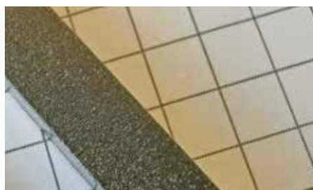
Mithilfe des Mikro-Wasserstrahls durch «Strahlhämmern» verdichtete Oberfläche.
