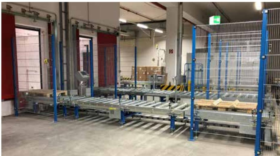
Im 1. OG wurde der bestehende Verteilerwagen (rechts im Bild) an die beiden Vertikalumsetzer angeschlossen. Bild: MLOG Logistics GmbH
