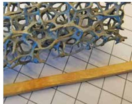
Laborversuch: Auch ultraleichte und deshalb druckempfindliche Metallschäume lassen sich problemlos mit dem Wasserstrahl bearbeiten. Bild: Klaus Vollrath
