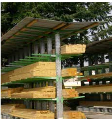
nen und Schliessen der spritzwasserdichten und luftdurchlässigen Schutzplane; unhandliche und schwere Rolltore oder Schiebetüren, wie sie bei marktüblichen Lösungen verwendet werden, sind nicht notwendig. Darüber hinaus sind die wettergeschützten Kragarmregale auch mit selbsttragendem Dach und als Kalthalle verfügbar. Wie alle Systemlösungen von ELVEDI ist das Wetterschutzregal modular konzipiert und wird jeweils nach individuellen Kundenanforderungen konstruiert.
