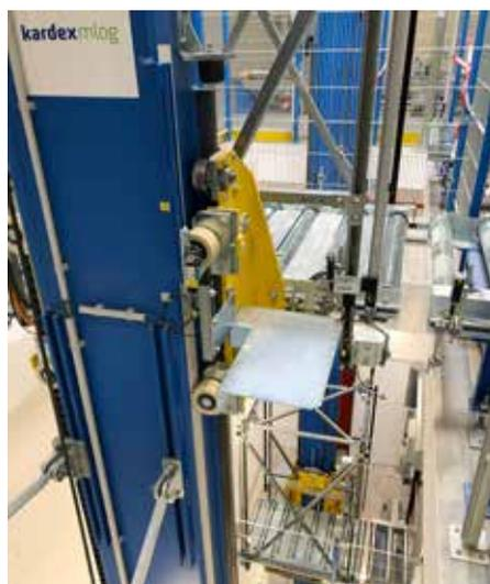
Die beiden Vertikalumsetzer bedienen alle drei Ebenen. Bild: MLOG Logistics GmbH
