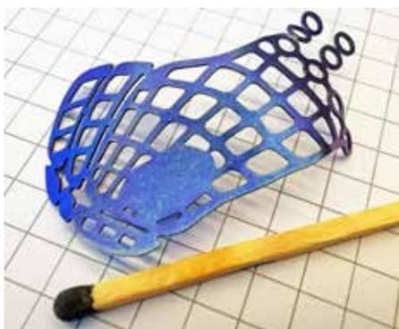
Mit dem Mikro-Wasserstrahl aus Titanblech geschnittenes Implantat für die Rekonstruktion schwerer Knochenverletzungen u.a. im Augenbrauenbereich. Bild: Klaus Vollrath
