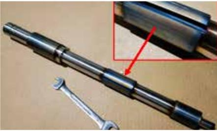
Die graue Oberfläche der Bundbereiche dieser Welle aus rostfreiem Stahl zeigt die erfolgreiche Härtung mithilfe des Induktionsverfahrens. Bild: Klaus Vollrath
