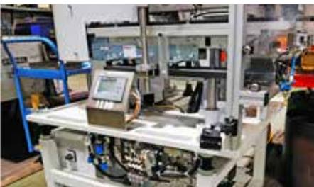
Rollwagen mit Handlingsystem für die automatische Zuführung von Massenteilen. Bei grösseren Serien kann der Wagen mit wenigen Handgriffen an eine sonst manuell bediente Anlage für das Induktionshärten von Kleinteilen angedockt werden. Bild: Klaus Vollrath
