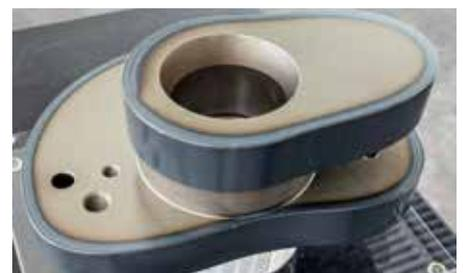
Die gesamte Prozesskette zur Herstellung dieser Doppel-Kurvenscheibe für eine Textilmaschine wurde erfolgreich auf Laserhärtung umgestellt. Bild: Klaus Vollrath
