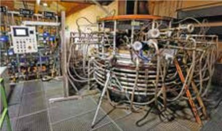
Bei der Härtereier Gerster selbst entwickelte und realisierte Anlage mit zahlreichen Brennern, Pyrometern und Regelzonen für das Flammhärten von runden Bauteilen mit Durchmessern bis 1,4 m und Höhen bis 650 mm. Bild: Klaus Vollrath
