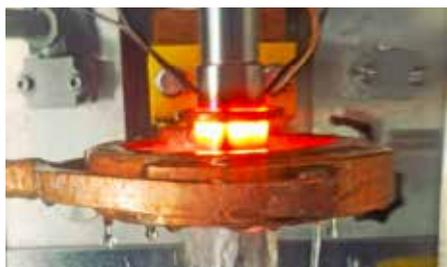
Automatisches induktives Randschichthärten des Bundes einer Welle im Durchlauf. Oben erzeugt der Induktor Rotglut, die rasche Abkühlung durch die nachfolgende Brause sorgt für die gewünschte harte Oberflächenschicht. Bild: Klaus Vollrath
