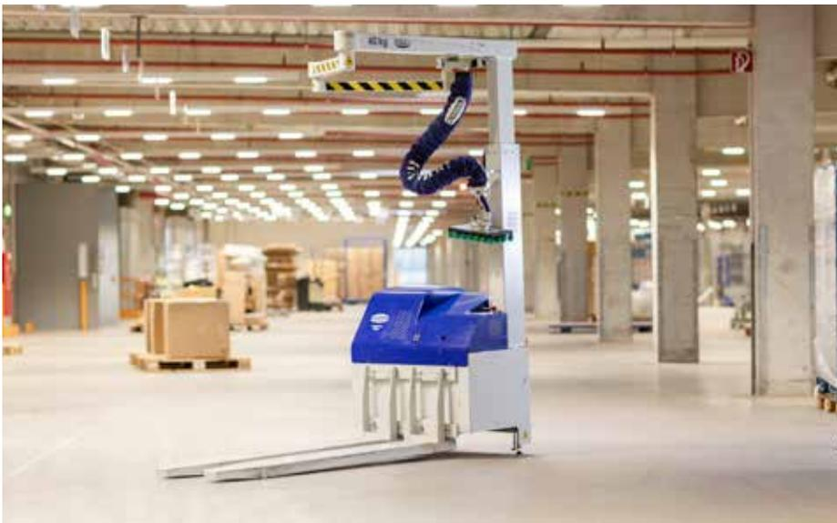
*Optimal auch für niedrige Deckenhöhen: Die Hubsäule des JumboFlex Picker ist in der Höhe elektrisch verstellbar.*
