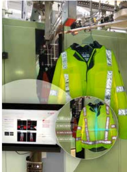
Die von MEWA und dem Fraunhofer Institut entwickelte automatische Warnschutzprüfanlage stellt sicher, dass Warnschutzkleidung auch nach der Wäsche den hohen Sicherheitsanforderungen entspricht.
