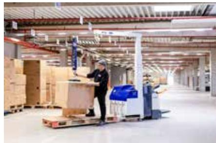
*Ergonomie zum Mitnehmen heisst es beim JumboFlex Picker, den Schmalz autark an ein Flurförderfahrzeug konstruiert hat.*
