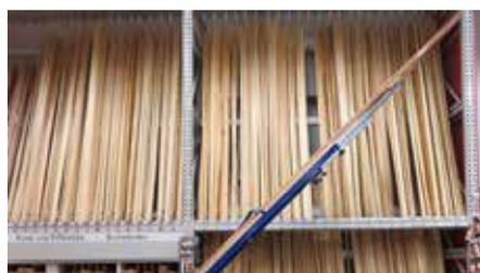
*Lange und sperrige Teile wie Arbeitsplatten oder Schrankkorpuse können mit dem kippLIFT einfach transportiert und aufgestellt werden.*
