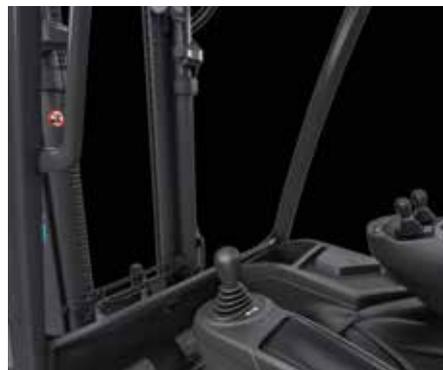
*Der Joystick als Alternative zum Lenkrad eignet sich für Einsätze mit langen, engen Gassen, beispielsweise Blocklager. Denn die Lenkräder drehen sich selbstständig in Geradeausstellung, wenn der Fahrer das Bedienelement loslässt.*
