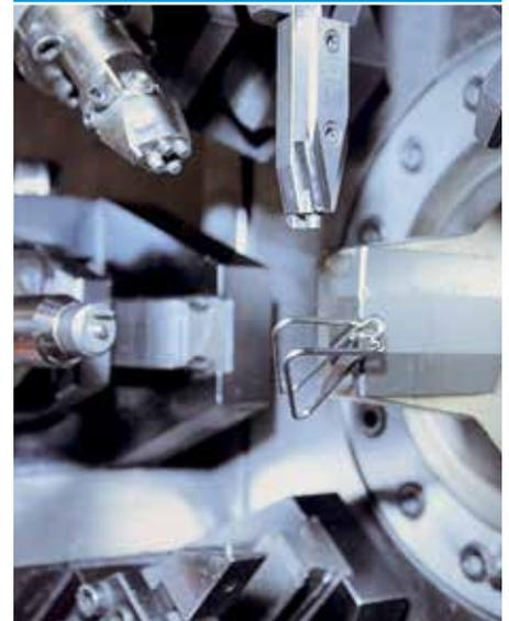
Unser hoher Automationsgrad erlaubt die Fertigung einfacher wie auch komplexer Federn und Drahtbiegeteilen. Kostengünstig und genau.
