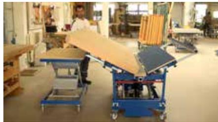
*Der wendoLIFT kippt das Werkstück mittels Hydraulik nach innen, sodass es nicht nach aussen fallen kann und ohne eine zusätzliche Fixierung auskommt.*
