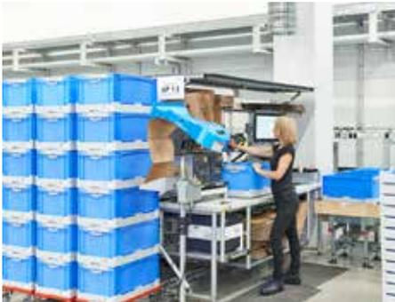
Wiederwendbar, sehr robust und besonders platzsparend ist die Klappbox BITO EQ. Zusammengeklappt reduziert sich der Platzbedarf für die Lagerung der Leerbehälter um 75 Prozent und spart somit viel Lagerfläche und -kosten ein. Bild: BITO-Lagertechnik
