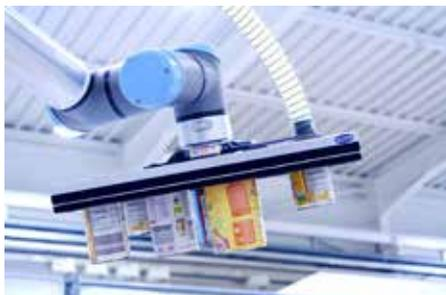
*Dank seines geringen Eigengewichts kann der Leichtbau-Lagengreifer ZLW von Schmalz auch an Leichtbaurobotern zum Handling ganzer Warenlagen eingesetzt werden. Bilder: Schmalz*
