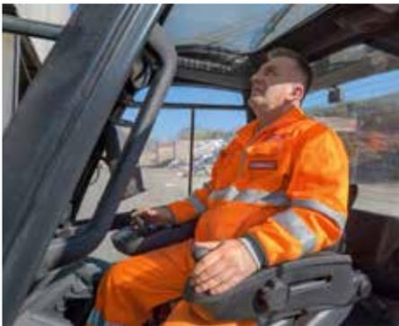
*Joystick statt Lenkrad: Bei der Linde Steer Control liegt der linke Arm des Fahrers auf einer Armlehne, den Stapler lenkt er mit Bewegungen der Hand um die Kurve. Entspanntes Sitzen und reduzierte Körperbewegungen entlasten ihn bei seiner Arbeit. Bilder: Linde Material Handling GmbH*
