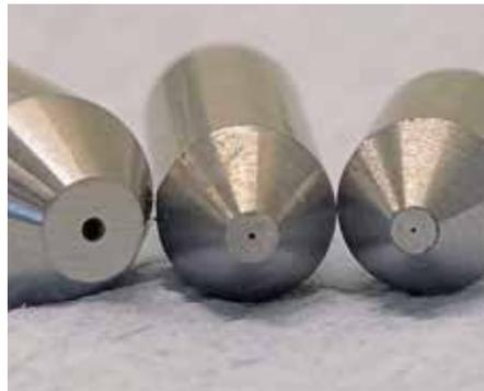
Generationsfolge: Handelsübliches Fokussierrohr mit 0,8 mm Ø (links), die bisher beim Mikro-Wasserstrahlschneiden üblichen 0,17 mm Ø (Mitte) und rechts die neueste Generation mit nur noch 0,15 mm Ø Foto: Klaus Vollrath
