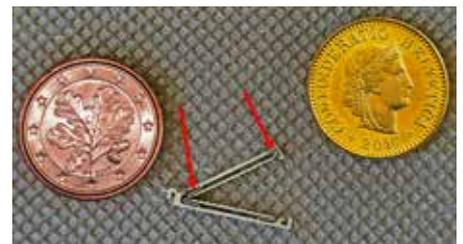
Mit dem Mikrowasserstrahl aus einem 1,15 mm dicken Blech der Memory-Legierung Nitinol geschnittenes Bauteil für ein medizinisches Implantat. Die dünnsten Stege (Pfeil) sind lediglich 100 µm dick Foto: Klaus Vollrath
