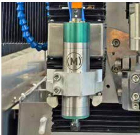
Die Hochfrequenzspindel mit 50.000 UPM ist in die Maschinensteuerung integriert Foto: Klaus Vollrath
