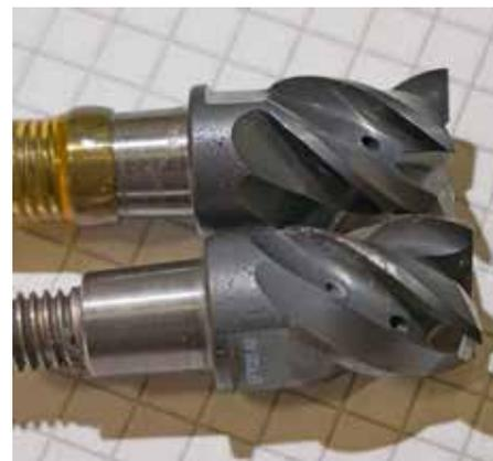
Mithilfe der Drehachse wurden in den Spannuten des unteren Fräasers zusätzliche Bohrungen bis zum inneren KSS-Kanal eingebracht, um den Späneabfluss zu verbessern Foto: Klaus Vollrath
