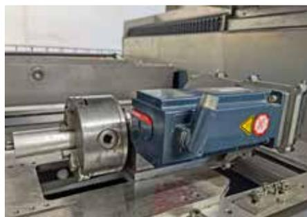
Auch die indexierbare Drehachse ist in die Anlagensteuerung integriert Foto: Klaus Vollrath
