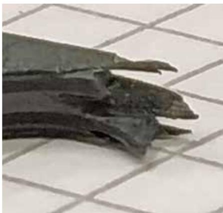
Die Spindel erzeugt in Faserverbundwerkstoffen wie CFK Startlöcher. Ohne diese würde das Wasser beim Versuch, das Material zu durchdringen, sich mit riesigem Druck zwischen die Schichten zwängen und den Werkstoff zerfetzen Foto: Klaus Vollrath
