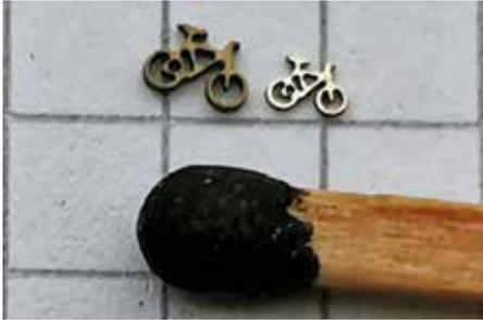
Durch intensive Weiterentwicklung konnte Waterjet den Durchmesser des Wasserstrahls von 170 µm (linkes Fahrrad) auf nur noch 150 µm (rechtes Fahrrad) verringern Foto: Klaus Vollrath
