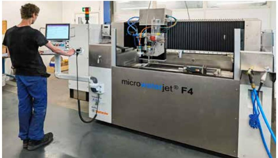
Die nagelneue F4 in der Forschungsabteilung ist mit der neuesten Version der Steuerung sowie diversen Extras wie Hochfrequenzspindel und Drehachse ausgestattet Foto: Klaus Vollrath
