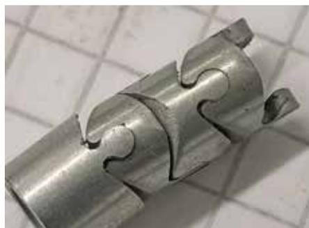
Auf der Drehachse aus einem Rohr geschnittene Folge von Kardankupplungen (Foto: Klaus Vollrath)
