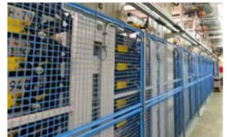
*Das Paternosterlager für maximal 82.000 Schilderpaare für PKW erreichte zeitweilig Belegungsquoten von bis zu 95 %. Foto: Klaus Vollrath*
