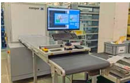
Die von Compar entwickelte Anlage. Vorne der Auflagebereich des Förderbandes mit Touchscreen-Bildschirm und Vorlaufstrecke. Im grauen Kasten befindet sich die Kamera. Nach optischer Kontrolle und ggf. Korrektur werden die Schilder entweder in die i.O.-Box oder in einen separaten „Kummerkasten“ befördert. Foto: Klaus Vollrath
