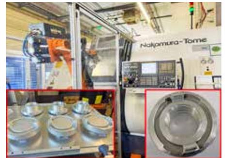
*Hochpräzise Bearbeitung wassersparender Schlauchkupplungen für Feuerwehr-Hydranten auf einem Drehfräszentrum. Dank Roboterbeschickung läuft die Fertigung rund um die Uhr* Foto: Klaus Vollrath
