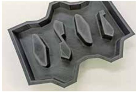
*Werkzeuglos aus ESD-Kunststoff erzeugte Prototypen oder Kleinstserien Foto: Klaus Vollrath*
