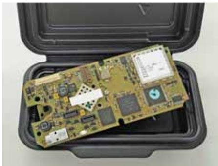
*Schutz für die wertvolle Elektronik: Eine massgeschneiderte Verpackung aus ESD-Kunststoff für eine Elektronikplatine Foto: Klaus Vollrath*
