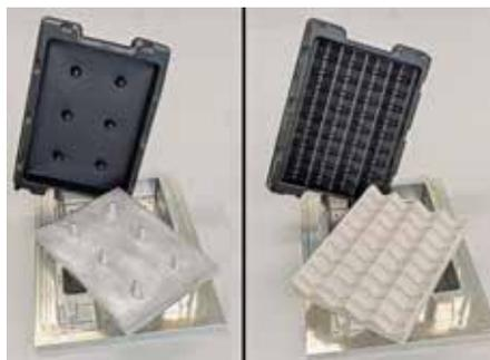
*Dank eines einheitlichen metallischen Formrahmens und variabler Einsätze aus Aluminium (links) oder 3D-gedruckter Keramik (rechts) entstehen unterschiedliche Tray-Varianten Foto: Klaus Vollrath*
