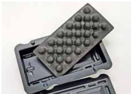
*Zweischalige Transportverpackung mit hinterschnittenen Noppenverschlüssen und formangepasster Einlage aus geschlossenporigem ESD-Polystyrol, einer Spezialität von Grütter Foto: Klaus Vollrath*
