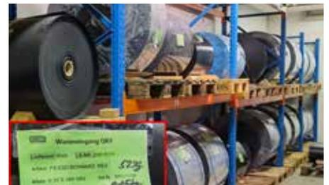
*Blick in eines der Lager mit Rollen von ESD-Folien aus unterschiedlichen Werkstoffen und in verschiedenen Abmessungen. Der Zusatz „REG“ auf dem Etikett weist das Material als Regenerat aus Foto: Klaus Vollrath*
