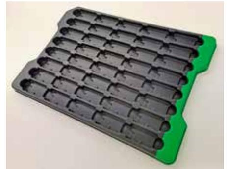
*Anwenderhilfen: Die abgeschrägte Ecke links oben verhindert „Verdreher“ beim Stapeln und der koextrudierte grüne Streifen hilft bei der Identifizierung des Produkts Foto: Klaus Vollrath*
