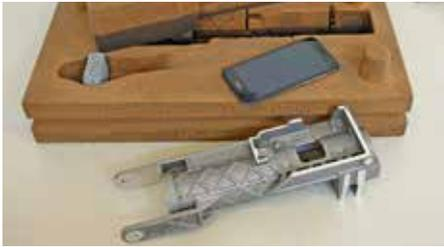
Im 3D-Druckverfahren hergestellte Sandform einschliesslich Kern sowie das damit im Serienverfahren und aus dem Serienwerkstoff hergestellte Prototyp-Gussteil Foto: Klaus Vollrath
