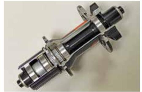
Diese sehr anspruchsvolle Fahrradnabe wird aus einem Schmiedeteil in einem 12-Achs-Bearbeitungszentrum in einer Aufspannung gefertigt. Damit lassen sich sogar die Löcher für die Speichen von innen ansenken Foto: Klaus Vollrath
