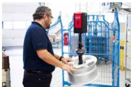
*Der Seilbalancer NEO 30 reagiert unmittelbar auf die Handbewegung des Werkers und unterstützt so das Heben und Senken von bis zu 30 Kilogramm schweren Lasten.*
