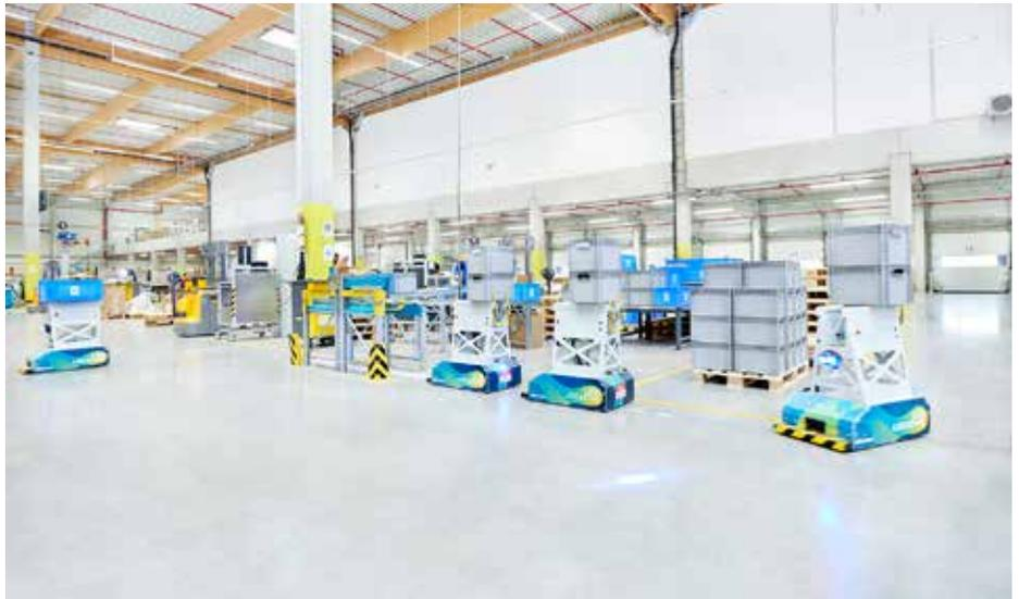
*Im Wareneingang nimmt LEO locative von BITO-Lagertechnik die bestückten Behälter auf. Diese werden von dort zunächst zu Qualitätsprüfungszwecken – je nach Inhalt – in verschiedene Bereiche gebracht. Bilder: atric Dressel für BITO-Lagertechnik*
