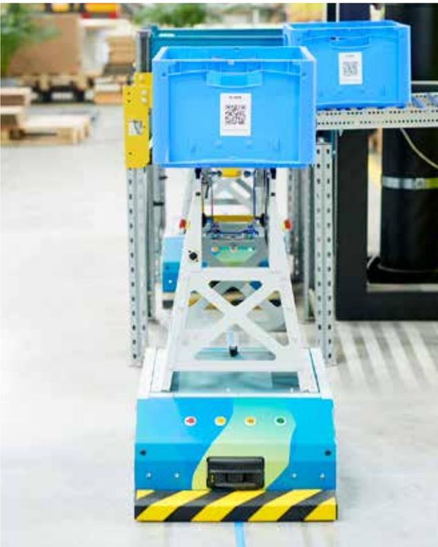
*Über Rollenbahnen gelangen die Behälter mit der kommissionierten Ware bei der BASF Logistik GmbH vom Arbeitsplatz zu einer vorgelagerten LEO locative Doppelstation. Hier nimmt der LEO Transporter den Behälter auf und bringt ihn zum Versandbereich. An einer im Versandbereich installierten LEO Doppelstation gibt das fahrerlose Transportsystem den Behälter ab, wo er vom Versanddienstleister entgegengenommen und für den Versand fertig gemacht wird.*
