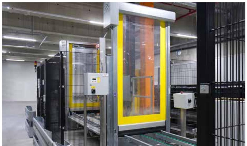
Paletten mit den Kästen über Fördertechnik, wiederum durch Maschinenschutzttore von EFAFLEX, in Vertikalförderer geschoben. Dort fahren sie auf die entsprechende Ebene. Welche Paletten jeweils in die Produktion gelangen, steuert je nach Auslastung der Fördertechnik das vollautomatische System.
