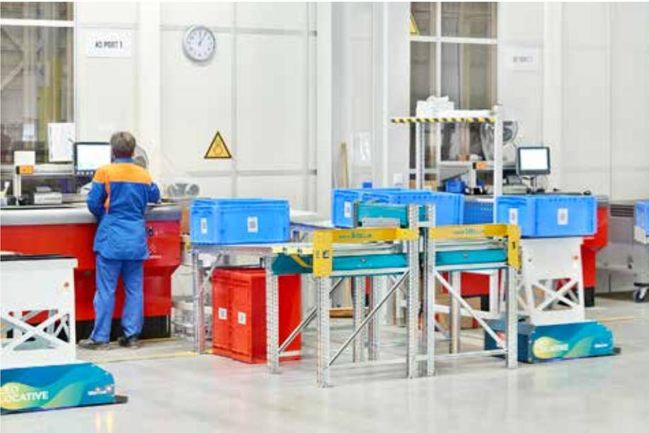
*LEO locative transportiert die Waren in Behältern aus dem Autostore-Lager zum Versandbereich. Die Strecke zwischen Warenausgang am Autostore-Kleinteilelager bzw. dem Kommissionierbereich zum Versandbereich ist eine relativ kurze Strecke. Dennoch spart die BASF Logistik GmbH durch den Einsatz des LEO locative-Systems sehr viel Zeit für den Transport der Waren und für den Rücktransport der leeren Behälter zum Autostore-Lager ein.*
