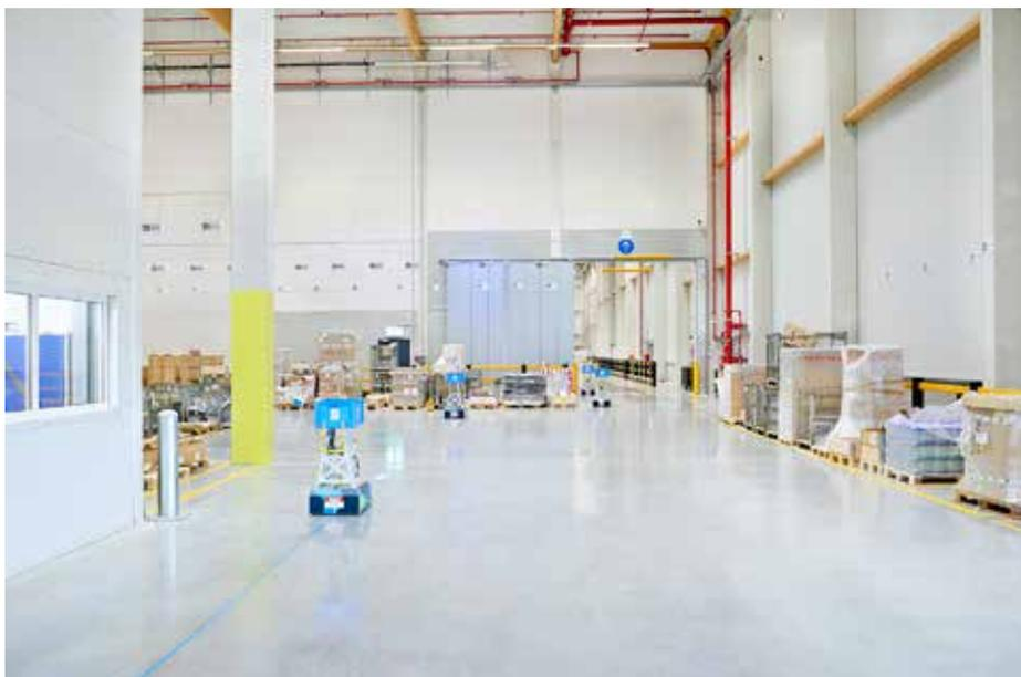
*Im Anschluss an die Qualitätsprüfung transportiert LEO locative die Behälter mit den geprüften Teilen über mehr als 100 Meter Wegstrecke in die Nachbarhalle, in der sich ein Hochregallager bzw. Autostore-Lager befindet.*
