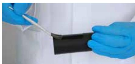
Das Polymersystem dichtol AM Hydro lässt sich gleichermassen einfach streichen, injizieren oder tauchen. Es verschliesst zuverlässig Poren bis zu 0,2 Millimeter Durchmesser.
