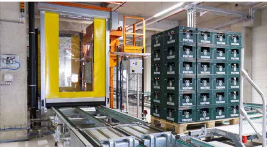
sehen. Auch farbige, hochreissfeste und querstabile Behänge sind ohne weiteres lieferbar. Alle Behangvarianten sind frei von lackbeetzungsstörenden Substanzen. Das Zusammenspiel einer leistungsstarken Frequenzumrichter-Steuerung und eines funktional angepassten Antriebs ermöglicht in Fertigungsprozessen die sehr hohe Taktzahl von bis zu sieben Zyklen pro Minute. Die Tore
