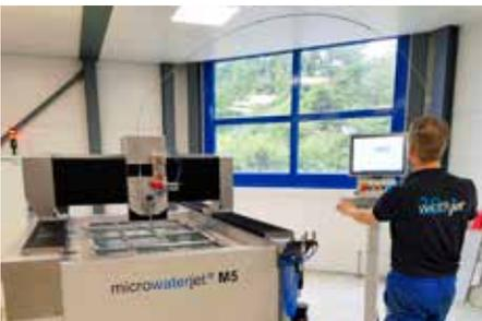
Die neue Mikro-Wasserstrahlschneidmaschine M5 von Waterjet kann Tafeln im Handelsformat 2.000 x 1.000 mm verarbeiten
