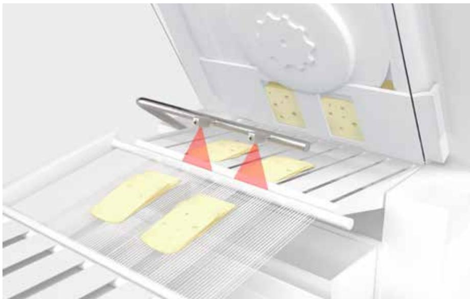
Lichttaster der Leuze Baureihe 53C sind im Hygiene-Design ohne Bohrlöcher konzipiert und bieten sich für Einsatzbereiche mit direktem Lebensmittelkontakt an. Sie erkennen auch die Vorderkanten von Schnittwaren zuverlässig.
