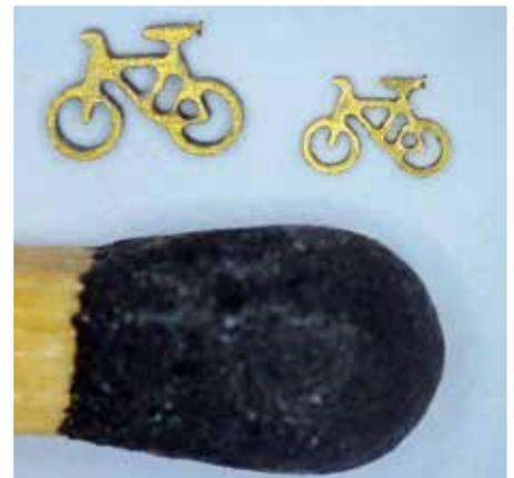
Dank der neu entwickelten Düsen mit einem Strahldurchmesser von nur noch 150 µm lassen sich noch filigranere Bauteile herstellen
