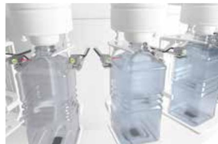
Den Füllstand wässriger Flüssigkeiten in Behältern zuverlässig zu erkennen, zählt zu den anspruchsvollsten Detektionsaufgaben. Hierfür braucht es besonders leistungsstarke Sensorlösungen wie die speziell für diese Applikation optimierten Einweg-Lichtschranken der Baureihe 55C von Leuze.
