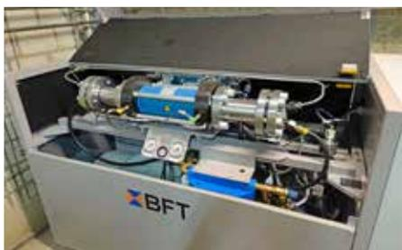
Die Steuerung der M5 kann den Schneidstrahl Druck dieser modernen Servopumpe je nach Erfordernis anpassen Foto: Klaus Vollrath
