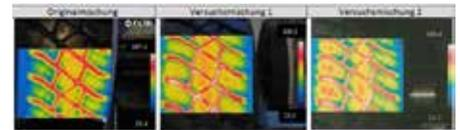
Infrarot-Aufnahmen von Reifenlaufflächen.
