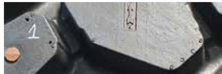
Abriebsensor in der Lauffläche eines Nutzfahrzeugs.
