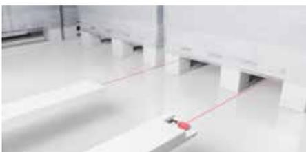
An fahrerlosen Transportfahrzeugen überwachen die optischen Sensoren ODT3CL1-2M beispielsweise die korrekte Aufnahme und Übernahme von Paletten.
