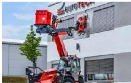
euroTECH bietet der Fenster- und Fassadenbaubranche ein spezielles Anbaumodul für Teleskoplader und Ladekräne an. Der eT-Litocran ermöglicht es, Fensterelemente auch in schwierigen Einbausituationen zu handhaben und Hindernisse zu überwinden.
