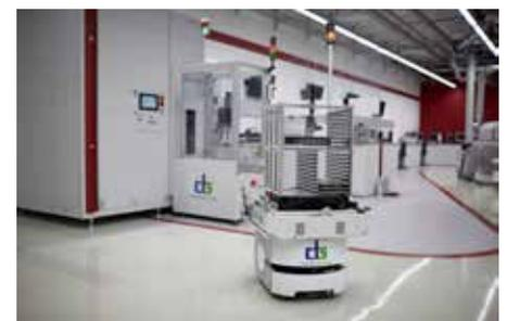
*Mit nahtlos in die bestehende Soft- und Hardwarelandschaft integrierten AMRs wird die Anlieferung der zu bestückenden Leiterplatten an den Linien zuverlässig und ohne Operator-Eingriffe abgewickelt.*
