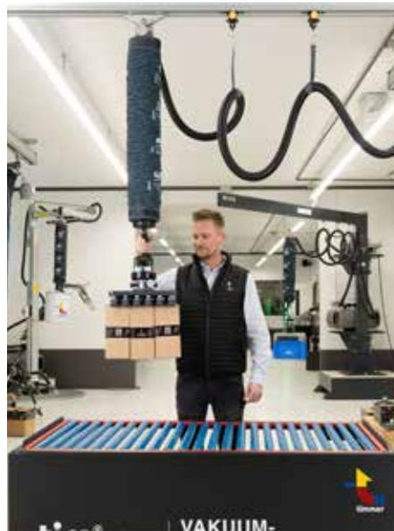
**Multisauger mit mehreren kleinen Kartons** Neu im Timmer-Programm ist der Multisauger. Seine 29 kleinen Balgsauger und die hohe Leckagetoleranz eröffnen ein breites Anwendungsfeld.
