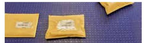
Die die semi-elastischen Förderbänder NAW und NSL verfügen über eine sehr griffige, stark adhäsive und antistatische Oberfläche.
