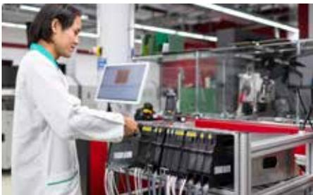
*Die Funktion Re-use organisiert und optimiert die Zwischenlagerung von Material in einem Active Feeder Rack im Vorrüstbereich.* Bild: ASMPT
