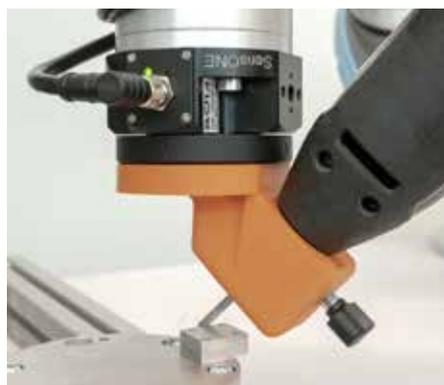
Der SensONE T5 ist ein 6-achsiger Kraftmomenten-Sensor, der für anspruchsvollste Anwendungen entwickelt wurde. Er ist in einem kompakten, staub- und wasserdichten Gehäuse untergebracht und lässt sich ohne Montageadapter einfach in Roboterarme integrieren.
