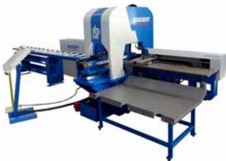
Die Stanzmaschine BOSCHERT CuProfi ist speziell zur Bearbeitung von Kupfer und Aluminium ausgelegt und verfügt über acht Werkzeugstationen.
