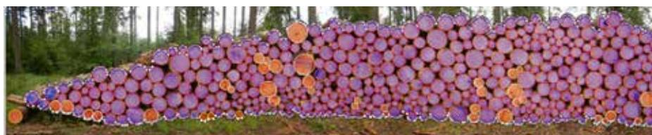
Die Software PolterMAX identifiziert die Anteile von Holz, Rinde und Luft auf den Bildern und rechnet das Volumen entsprechend auf den ganzen Polter hoch. Bilder: GDD-IT
