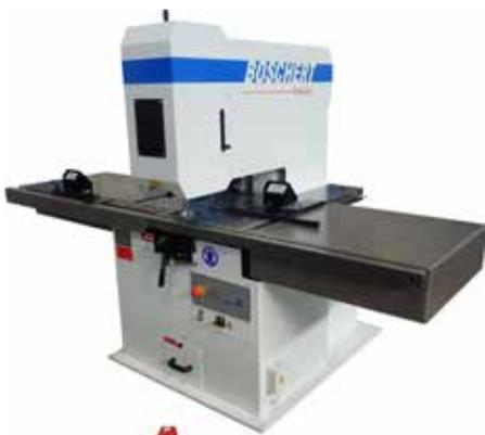
Das kleine, manuelle Bearbeitungszentrum Evoline 300 CU zum Trennen und Stanzen von Kupferleisten bietet eine Stanzkraft von 400 Kilonewton bei einem maximalen Stanzdurchmesser von 120 Millimetern.
