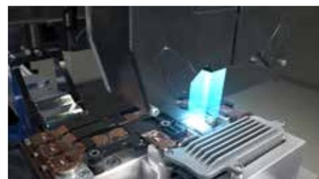
Automatische Überprüfung der Schweißnähte mit Triangulationssensoren in einem Doppelkopf-Messsystem
