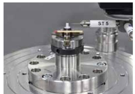
Taktile Vermessung auf einem Drehtisch mit einem Tastkugeldurchmesser von 0,2 Millimetern
