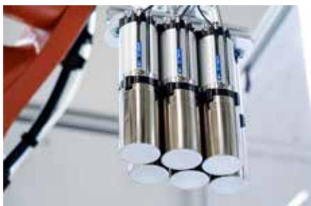
Der Magnetgreifer SGM-SV-BY gestattet das prozesssichere Handling von Rundzellen auch in schnellen Pick-and-Place-Prozessen Bild: J. Schmalz GmbH
