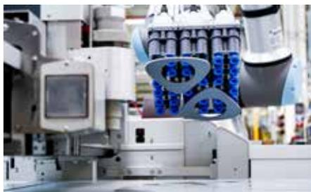
Dank des modularen Aufbaus greift der Matrix-Flächengreifer FMG beinahe jede Geometrie prozesssicher.
