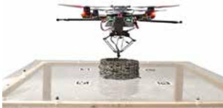
*3D-Druck mittels Drohne: Während des gesamten Bauprozesses bewertet die Drohne die gedruckte Geometrie in Echtzeit, um sicherzustellen, dass sie eine Fertigungsgenauigkeit mit einer maximalen Abweichung von fünf Millimetern einhält.*
