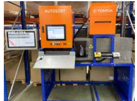
Im Testlabor von Henkel werden Konsumgüterverpackungen mit dem neuen Scannersystem frühzeitig auf ihre Sortierfähigkeit geprüft. Bild: Henkel AG & Co. KGaA
