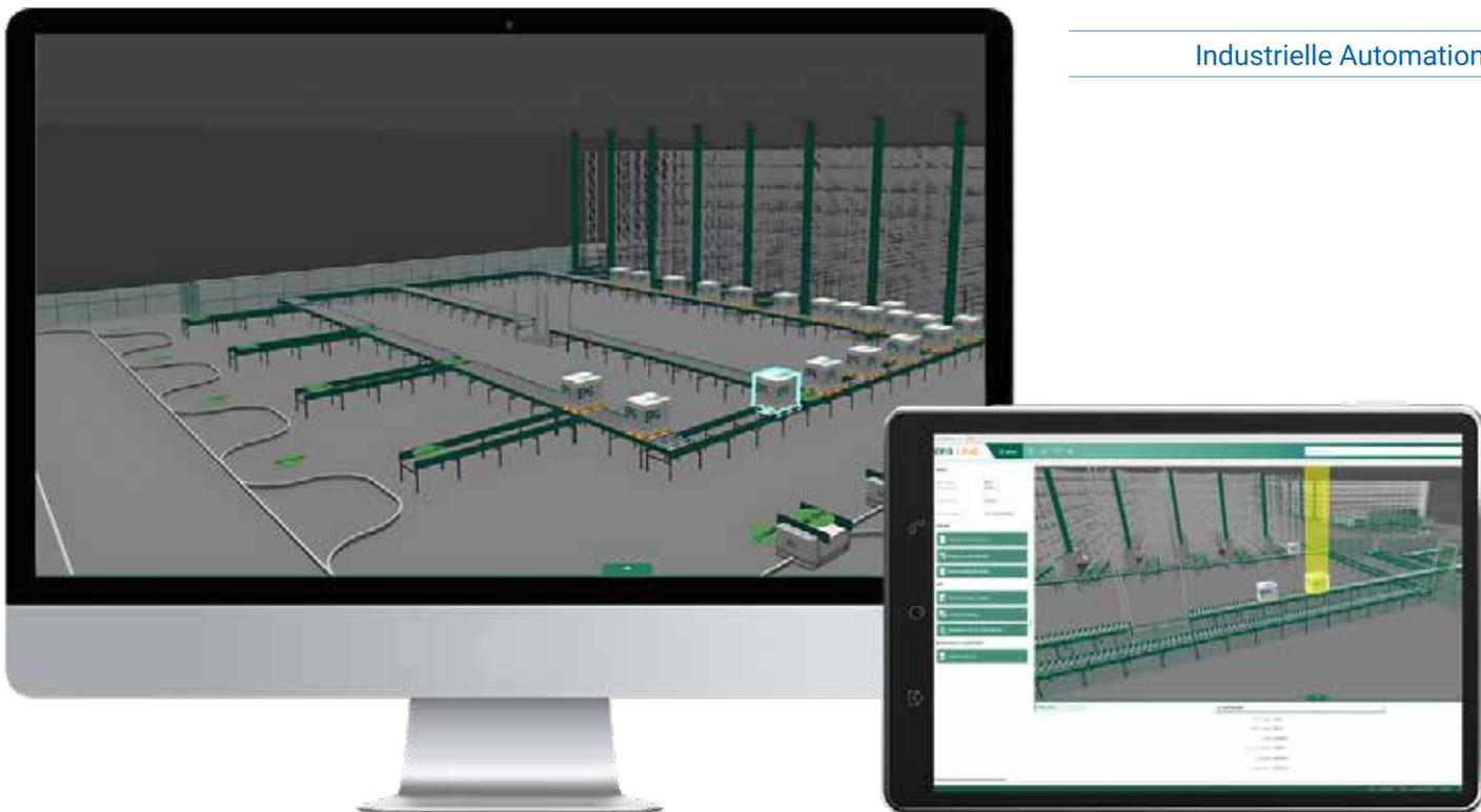
Der digitale Zwilling im Warehouse Control System (WCS) von EPG ermöglicht durch 3D-Materialflussvisualisierung realistische Tests und Prozessoptimierungen in einer virtuellen Umgebung. Die immersive 3D-Ansicht unterstützt die Systemüberwachung und Steuerung bereits vor Betriebsstart, optimiert Materialflüsse und ermöglicht eine nahtlose Integration der Technologie. Bild: EPG
