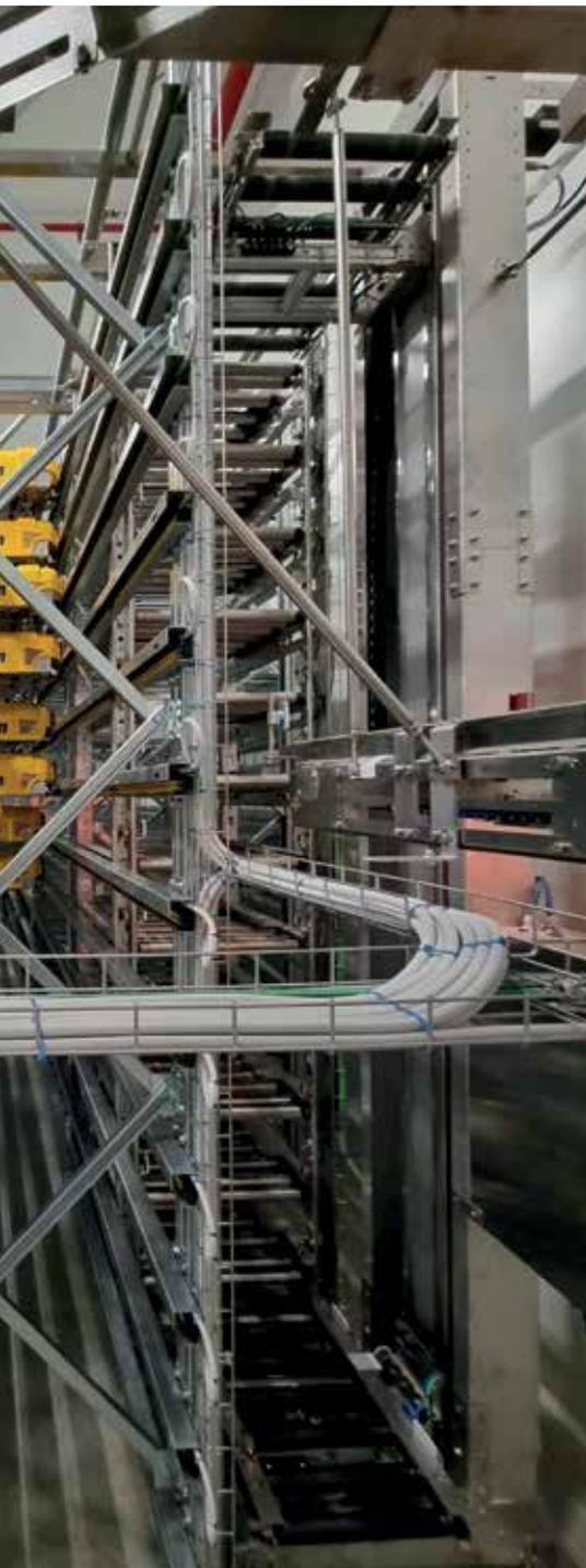
chaotisch in E2-Boxen angeliefert werden, zunächst im FSP-Shuttle-Lager gesammelt. Sobald 9 Boxen desselben Produkts mit der gleichen Losnummer zusammen sind, werden sie automatisch gestapelt und ins GKL umgelagert.
