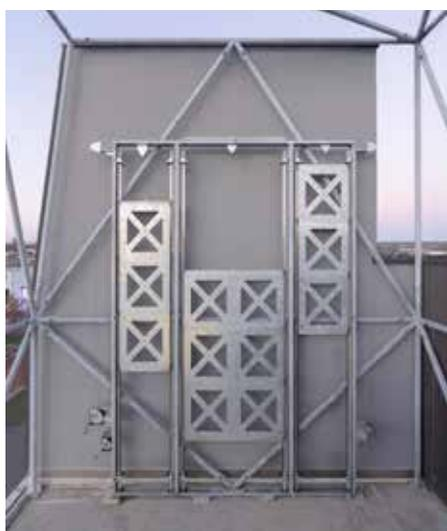
Un mur avec des éléments de surface interchangeables pour la fabrication additive aérienne. Images : ROK Architects
